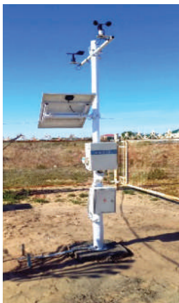
2-rasm. Foydalanilgan WX-QC meteorologik va havo sifatini o'lchash stansiyasi
